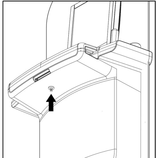
Abbildung 117: Tastaturfach-Verriegelungsknopf (Premium-Workstation)
