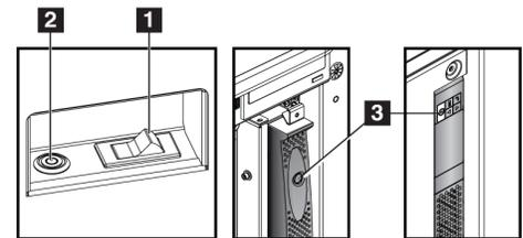
Abbildung 18: Netztasten an der Standard-Akquisitions-Workstation
