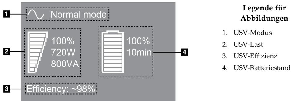
Abbildung 115: USV LCD-Display
