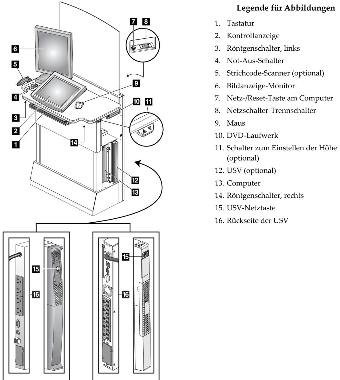
Abbildung 14: Bedienelemente und Anzeigen der Standard-Akquisitions-Workstation
