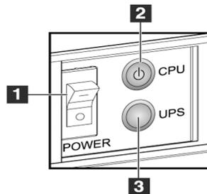
Abbildung 17: Netztasten an der Premium-Akquisitions-Workstation
