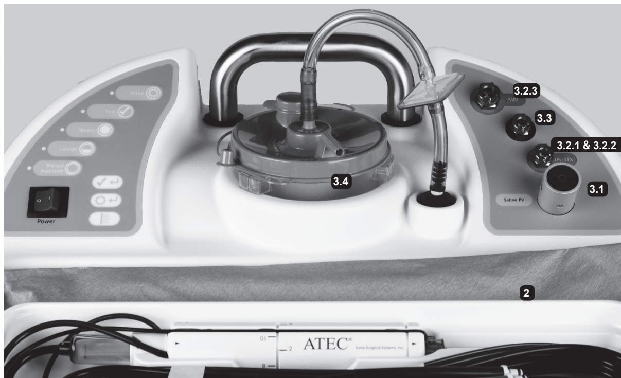
図4: 真空およびハンドピースの組立と接続
