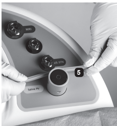
図 6: 生理食塩水のピンチバルブ接続
