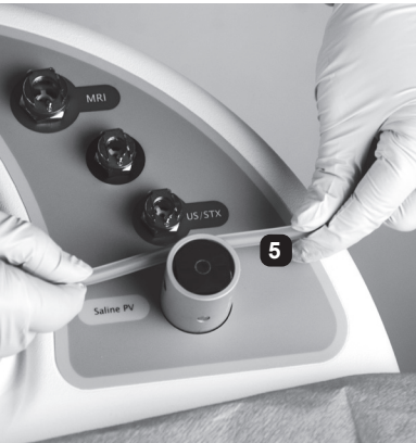
图 6: 连接盐水夹管阀
