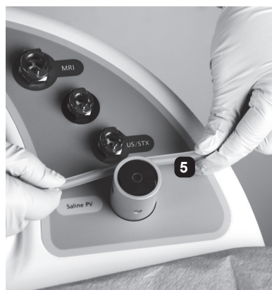
FIGURA 6: COLLEGAMENTO DELLA VALVOLA A MANICOTTO DELLA SOLUZIONE FISILOGICA
