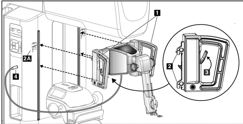
Figure 8 : Installation du module de guidage de biopsie
