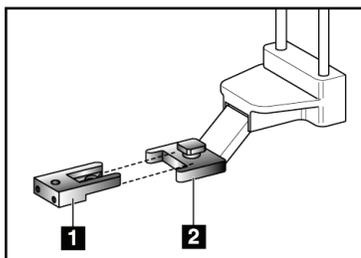
Figure 11 : Installation du guide d'aiguille jetable sur le support de guide d'aiguille standard
