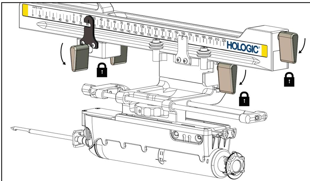
Figure 27 : Verrouillez les leviers en position complètement verrouillée
