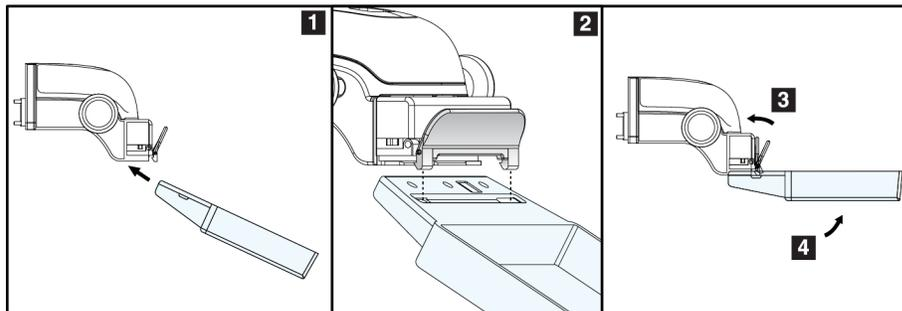
Figure 65 : Pour installer une pelote de compression
