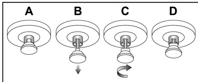
*Figure 104 : Dégagement du plateau de la position verrouillée
