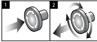
Figure 20 : Fonctionnalité du bouton d'arrêt d'urgence
