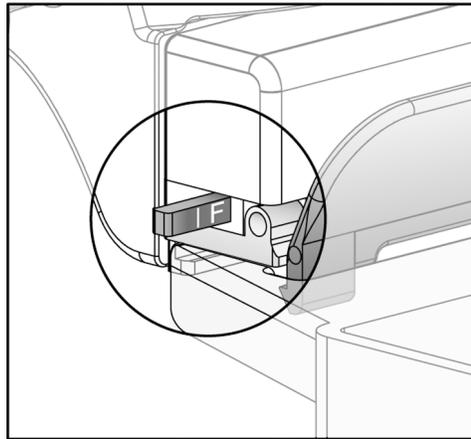
*Figure 67 : Bouton coulissant du mode de compression FAST*
