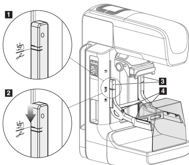
Figure 68 : Installation de la plaque d'agrandissement
