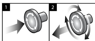
Figure 3 : Fonctionnalité du bouton d'arrêt d'urgence
