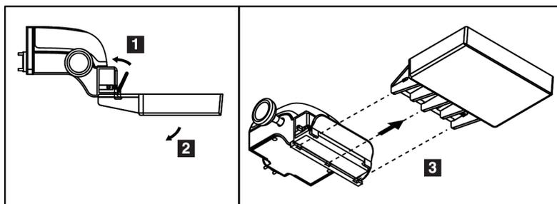
Figure 66 : Pour retirer une pelote de compression
