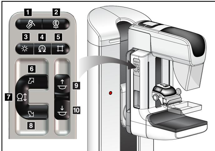
Figure 19 : Panneau de commande du bras en C
