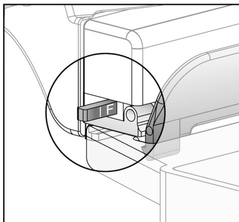
Figura 64: Cursore della modalità di compressione FAST
