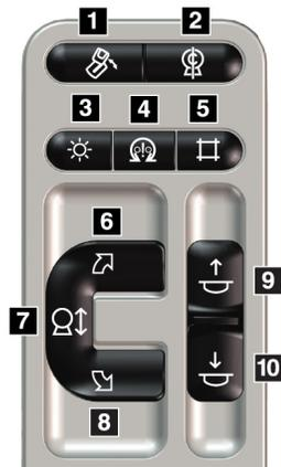
Figura 10: Pannello di controllo del braccio a C
