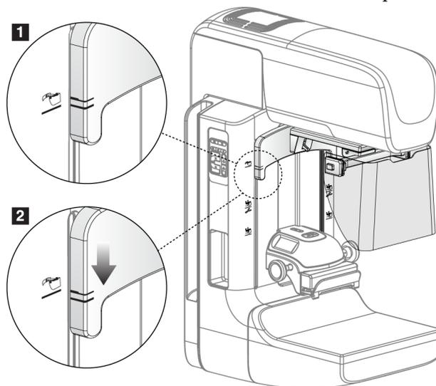
Figura 58: Allineamento dello schermo facciale retrattile sul braccio a C
