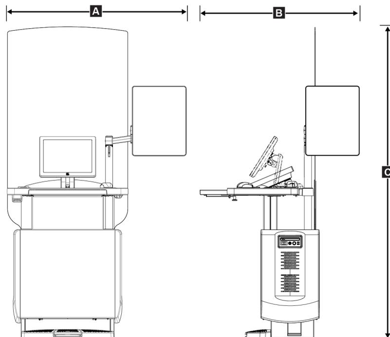
Figura 97: Misure della stazione di acquisizione universale
