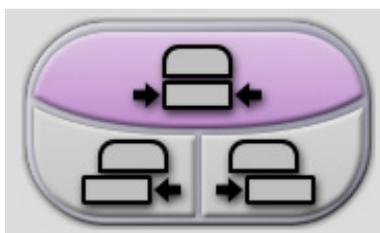
Figura 31: Pulsanti di spostamento della piastra di compressione
