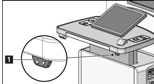
Figura 82: Painel de controle de ajuste de altura
