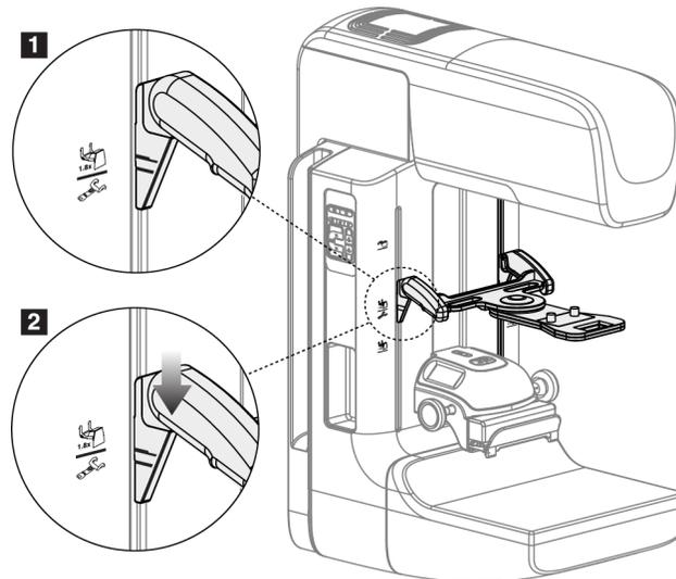
Figura 69: Instalação do dispositivo do retículo de localização
