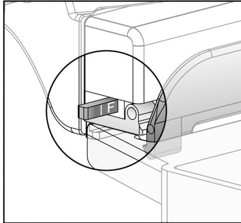
Figura 67: Controle deslizante do modo de compressão FAST
