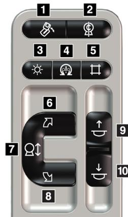
Figura 10: Painel de controle do braço-C
