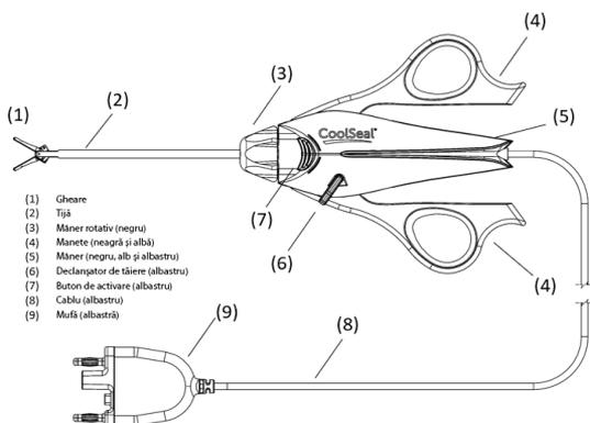
1. Scoateți instrumentul din tavă trăgând ferm de mâner (5). Nu trageți de ghearele instrumentului (1), de tijă (2) sau de cablu (8).
