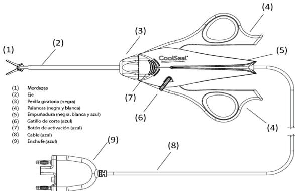
1. Extraiga el instrumento de la bandeja tirando firmemente de la empuñadura (5). No tire de las mordazas (1), del eje (2) ni del cable del instrumento (8).
