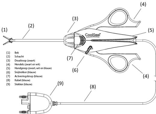
1. Verwijder het instrument uit de tray door stevig aan de handgreep (5) te trekken. Trek niet aan de bek (1), schacht (2) of kabel (8) van het instrument.
