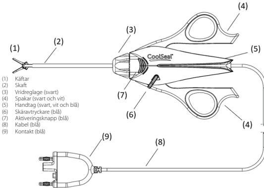
1. Ta bort instrumentet från brickan genom att dra bestämt i handtaget (5). Dra inte i instrumentets käftar (1), skaft (2) eller kabel (8).
