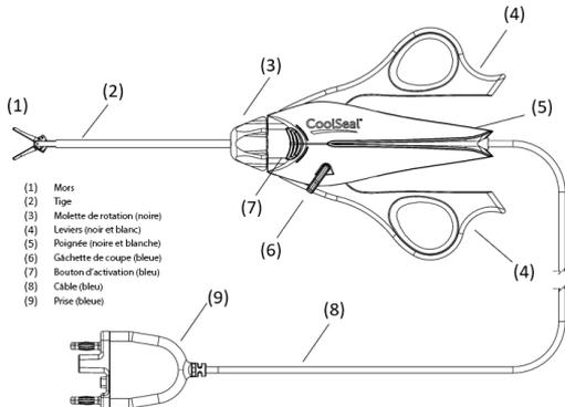
1. Retirer l'instrument du plateau en tirant fermement sur la poignée (5). Ne pas tirer sur les mors (1), la tige (2) ou le câble (8) de l'instrument.
