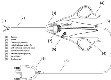
1. Das Instrument durch festes Ziehen am Griff (5) aus der Schale nehmen. Nicht an den Backen (1), am Schaft (2) oder am Kabel (8) des Instruments ziehen.
