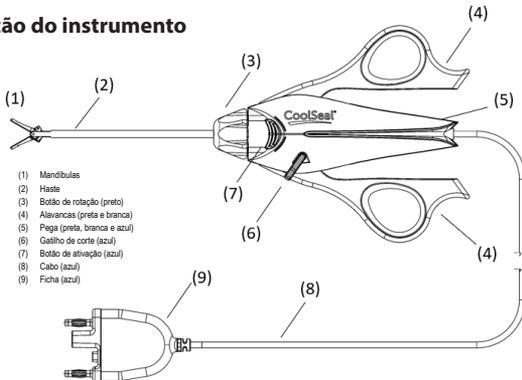
1. Retire o instrumento do tabuleiro, puxando firmemente pela pega (5). Não puxe pelas mandíbulas (1), pela haste (2) ou pelo cabo (8) do instrumento.
