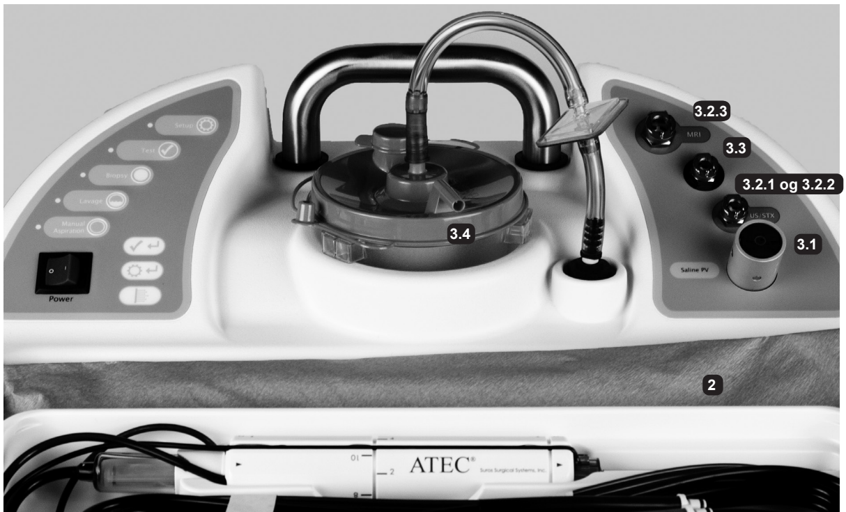
FIGUR 4: MONTERING OG TILSLUTNING AF VAKUUM OG HÅNDSTYKKE
