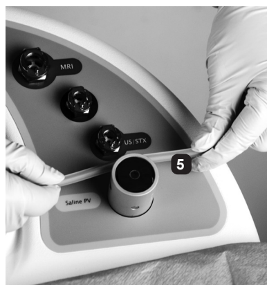
FIGURA 6: COLLEGAMENTO DELLA VALVOLA A MANICOTTO DELLA SOLUZIONE FIOLOGICA
