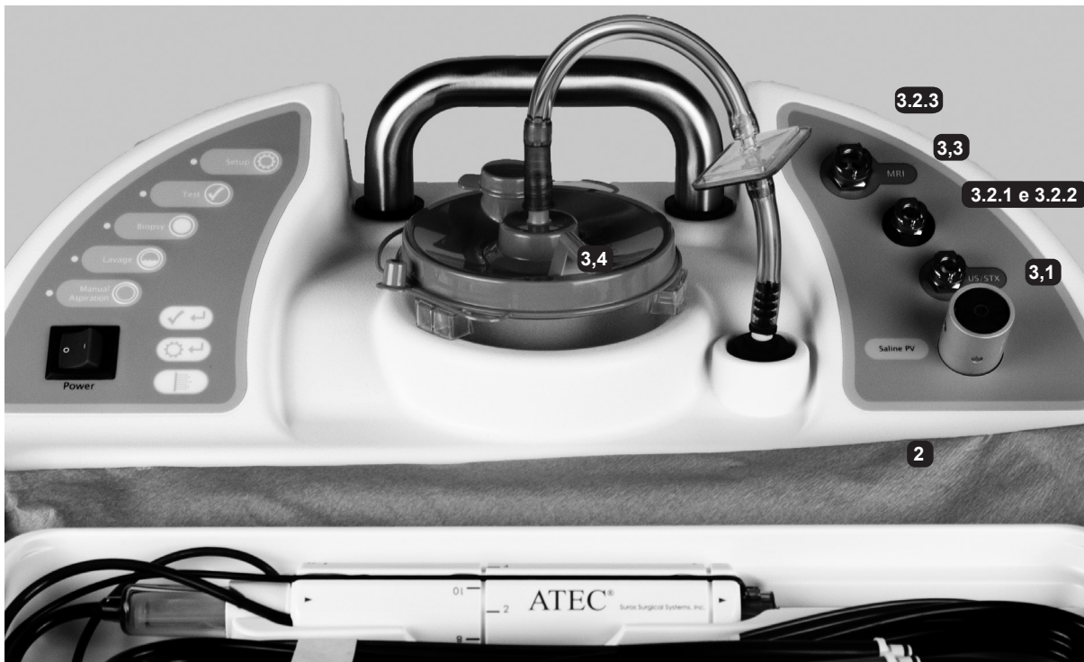
FIGURA 4: CONJUNTO E CONEXÕES DE VÁCUO E MANOPLA
