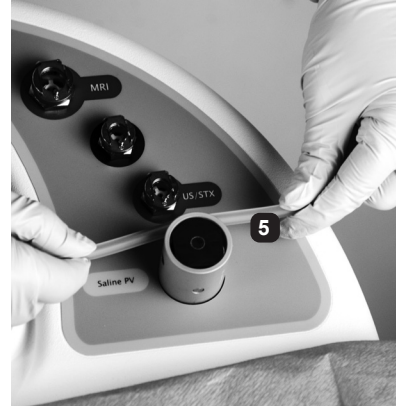
ŞEKİL 6: SALİN SIKIŞTIRMA VALFİ BAĞLANTISI
