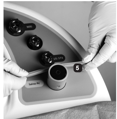
ABBILDUNG 6: ANSCHLUSS AN DAS KOCHSALZLÖSUNGS-QUETSCHVENTIL
