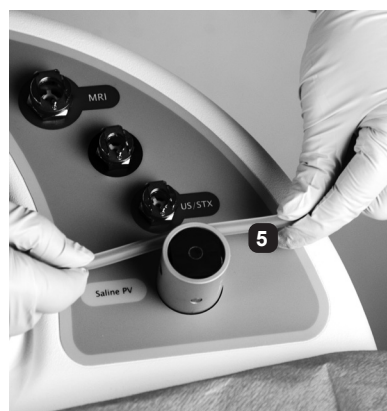
FIGURE 6 : RACCORDEMENT DU ROBINET À MANCHON DÉFORMABLE DE SÉRUM PHYSIOLOGIQUE
