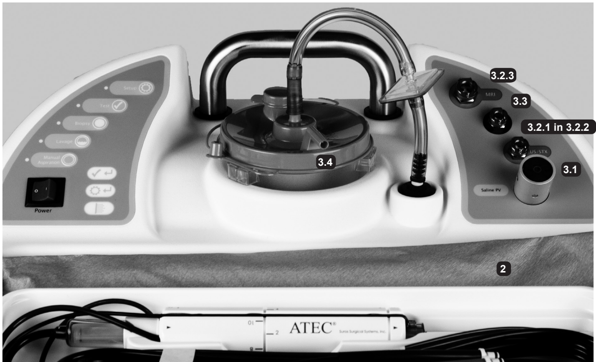
SLIKA 4: SESTAVLJANJE IN PRIKLJUČKI ZA VAKUUM IN ROČNIK
