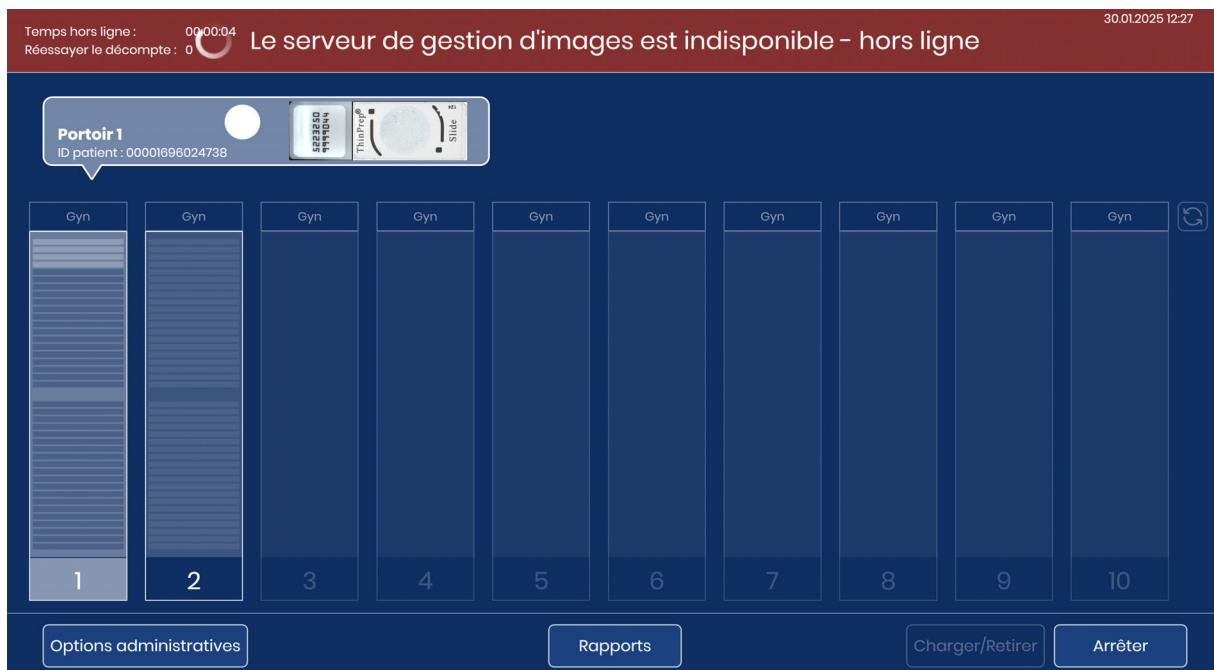
**Figure 1-6-1 Absence de connexion entre le serveur de gestion des images et l'imageur numérique**
