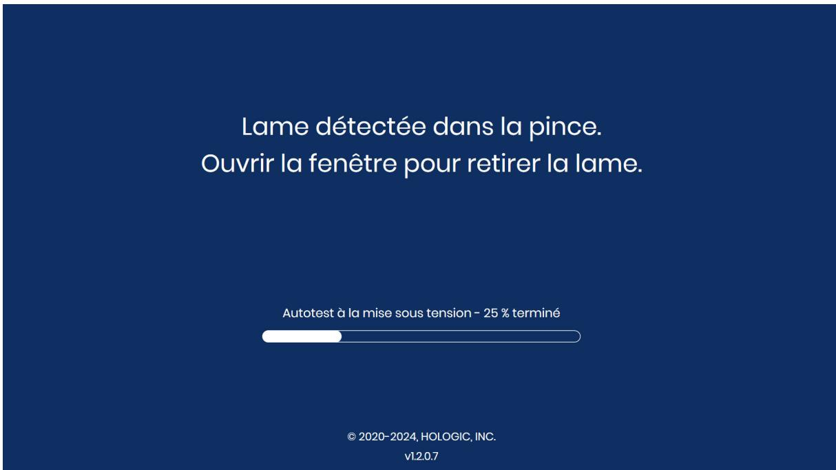
**Figure 1-6-7 Récupération d'une erreur assistée par l'utilisateur : ouvrir la fenêtre pour retirer une lame**
