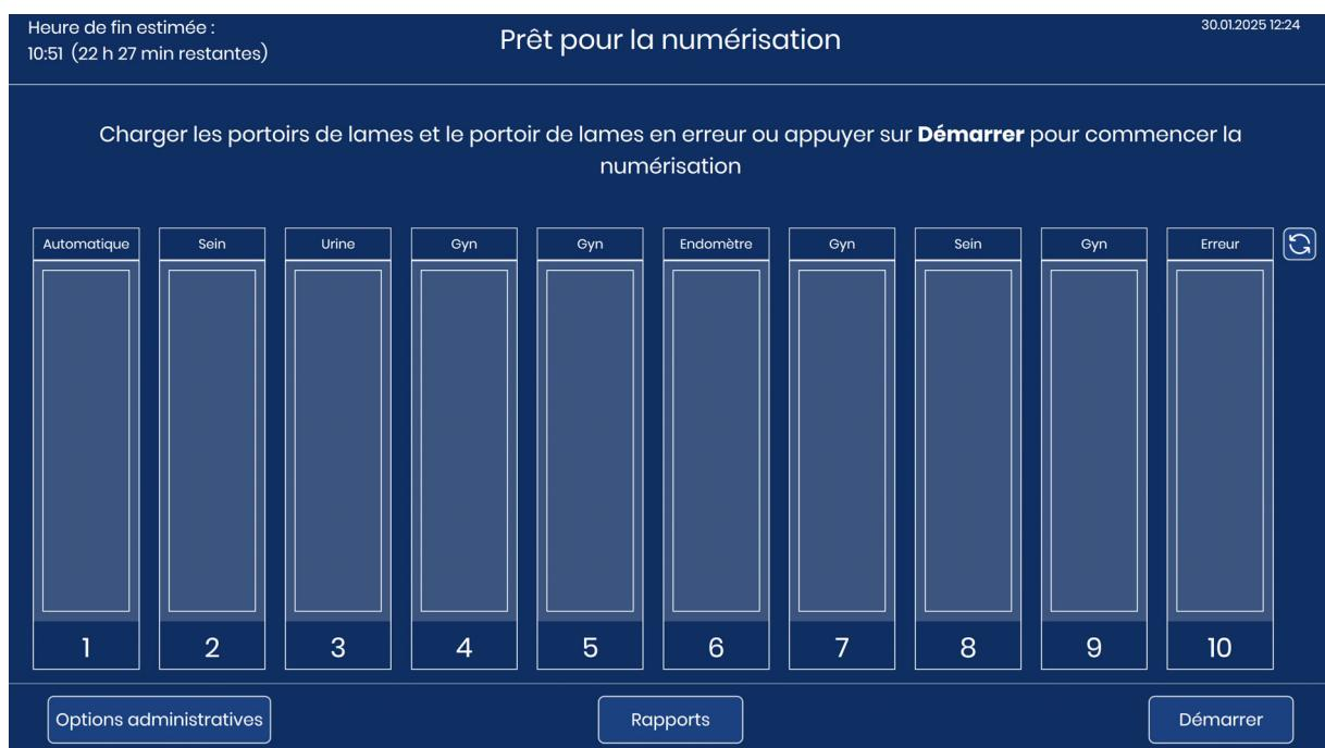
**Figure 1-4-10 Commencer la numérisation des lames : charger les portoirs de lames ou appuyer sur Démarrer**
