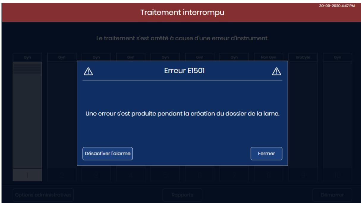
**Figure 1-6-3** Notification de l'utilisateur : erreur récupérable (exemple)
