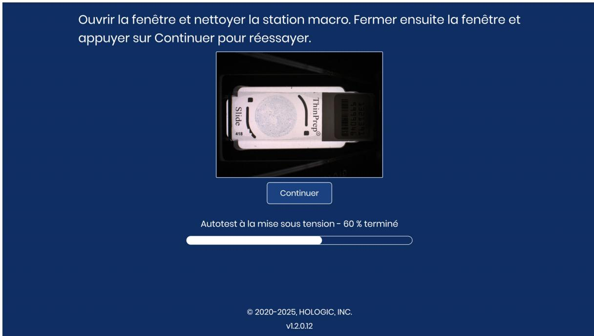
**Figure 1-6-10 Enlever les débris de la station de macrolecture, exemple**
