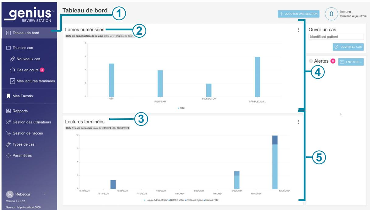
**Figure 1-3-20 Tableau de bord de la station de lecture, applications par défaut Lames numérisées et Lectures terminées**
