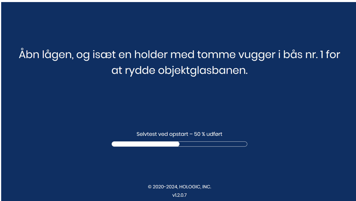
Figur 1-6-6 Brugerassisteret genoprettelse efter fejl: isæt en tom objektglasholder
