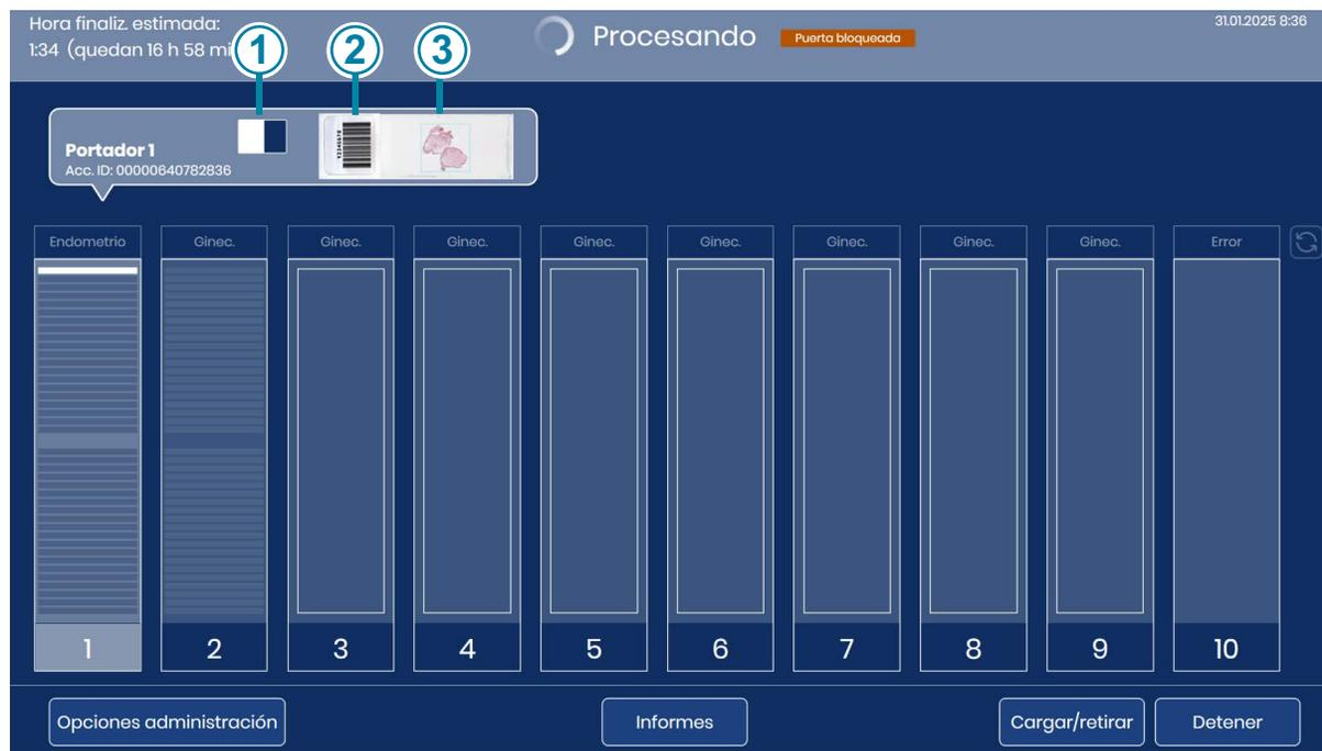
**Figura 3-2-4** Indicador de zona de exploración, ejemplo de Detectar muestra
