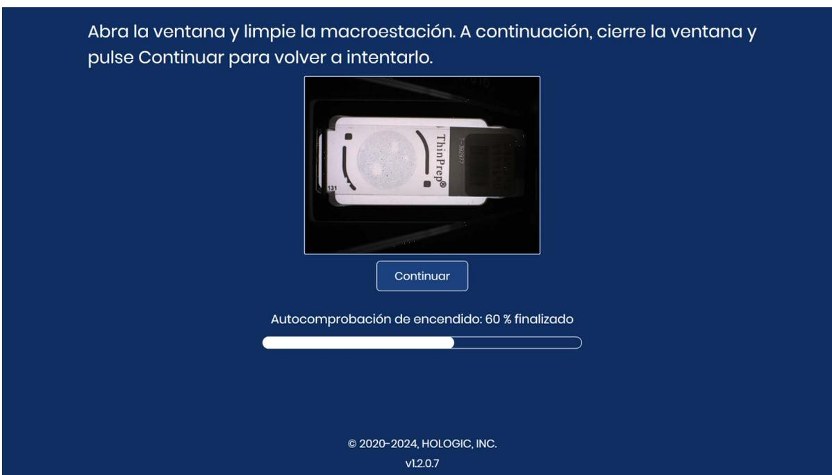
**Figura 1-6-10 Retire los residuos de la estación de macro, ejemplo**
