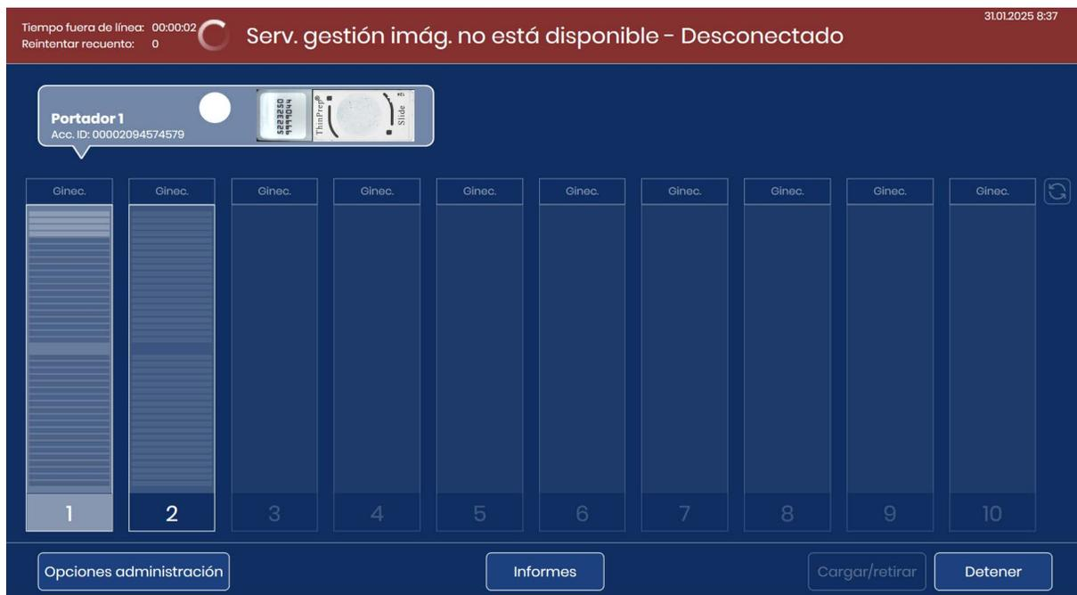
**Figura 1-6-1 No hay conexión entre el servidor de gestión de imágenes y el generador de imágenes digitales**
