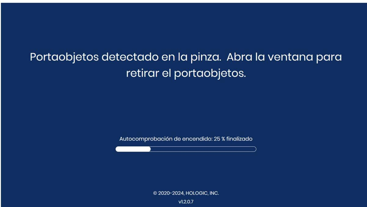
**Figura 1-6-7 Recuperación de errores con ayuda del usuario: abra la ventana para retirar el portaobjetos.**
