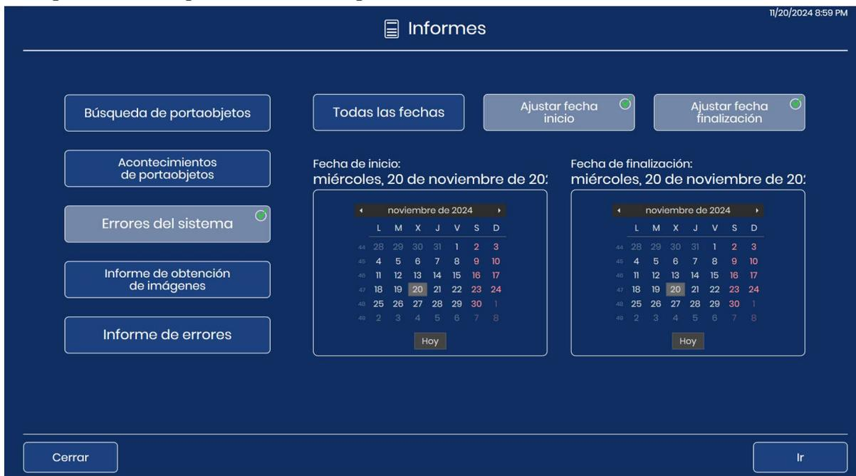
**Figura 1-3-39 Errores del sistema: establecer el intervalo de fechas y tocar Ir**
