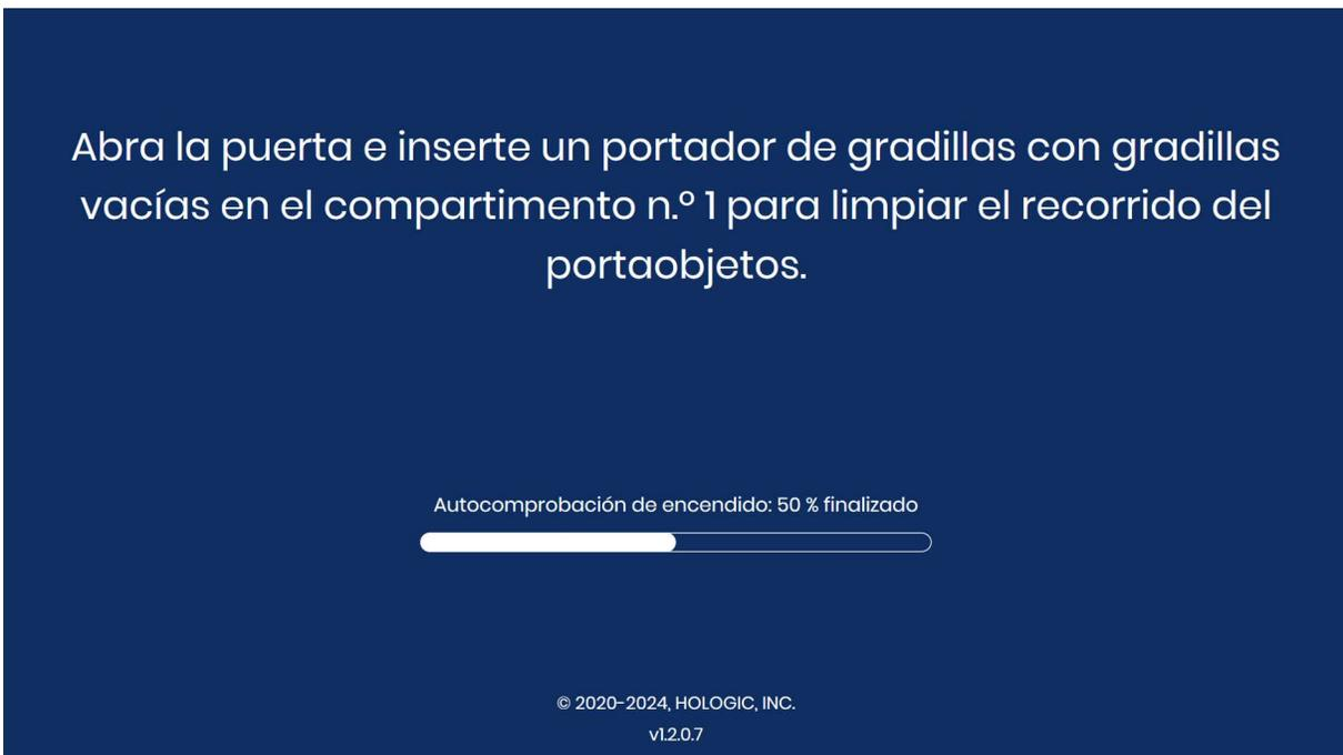
**Figura 1-6-6 Recuperación de errores con ayuda del usuario: cargar un portador de portaobjetos vacío**
