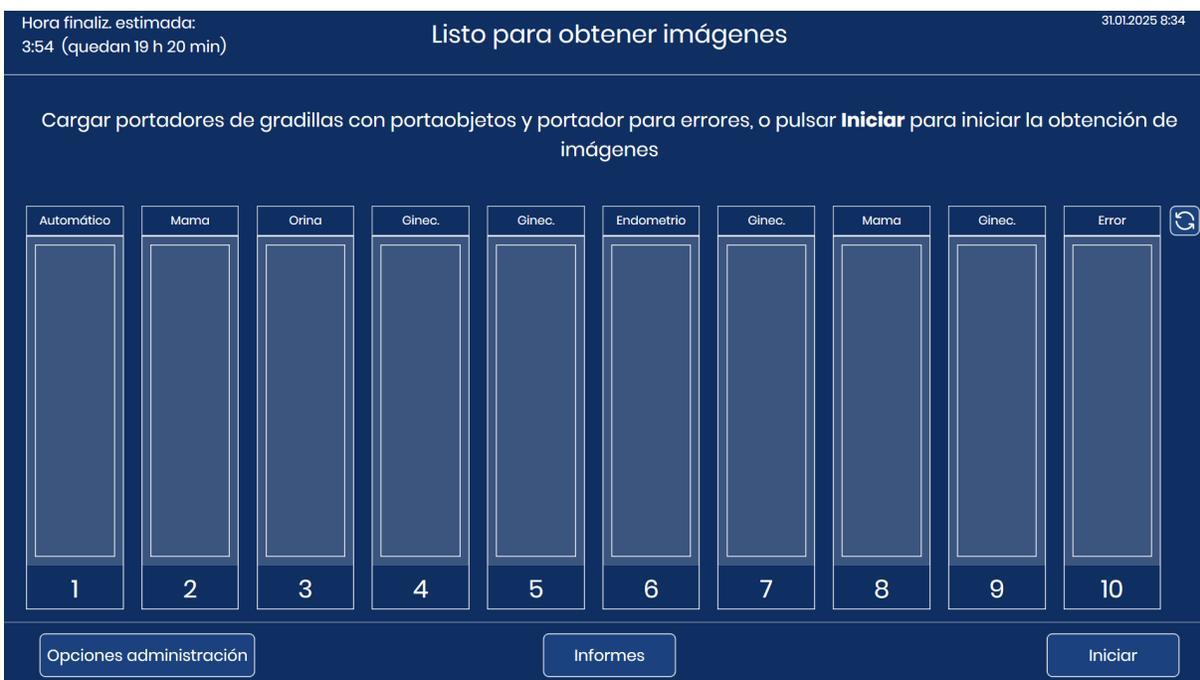
**Figura 1-4-10 Iniciar la obtención de imágenes de portaobjetos: cargue portadores de portaobjetos o pulse Iniciar**
