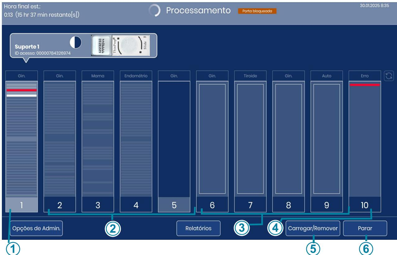
**Figura 1-4-11 Estado da leitura de imagens do suporte de lâminas (exemplo)**
