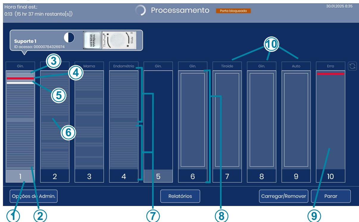
**Figura 1-3-3 A apresentação no ecrã indica a posição do suporte de lâminas**
