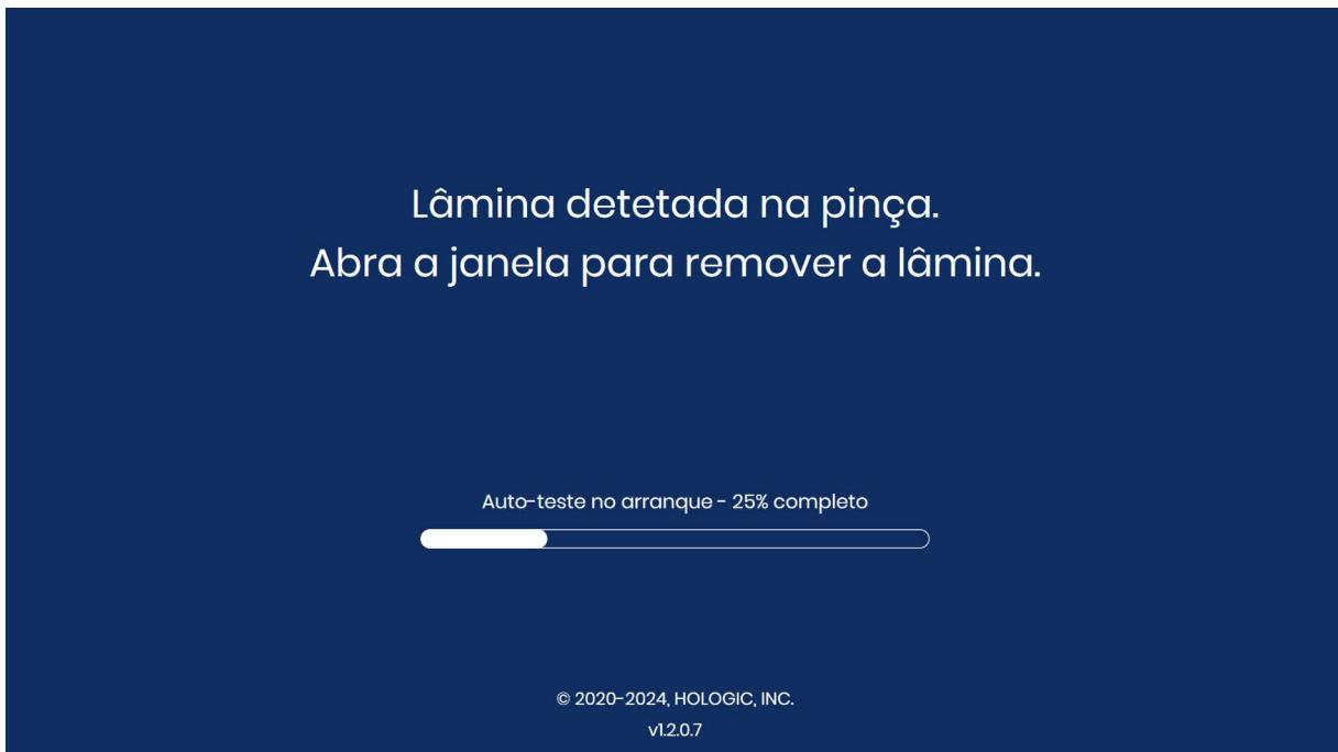
**Figura 1-6-7 Recuperação do erro assistida pelo utilizador: abrir a janela para remover a lâmina**
