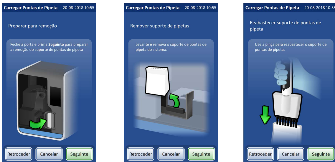
Figura 7-11 Carregar ponteiras de pipeta no suporte de ponteiras de pipeta
