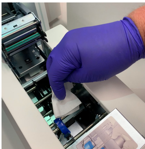
Figura 8-10 Limpar os rolos de transporte da impressora de lâminas
