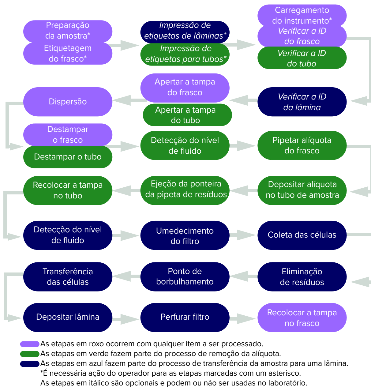
Figura 1-3 Processamento de lâminas e remoção de alíquotas no processador ThinPrep™ Genesis™
