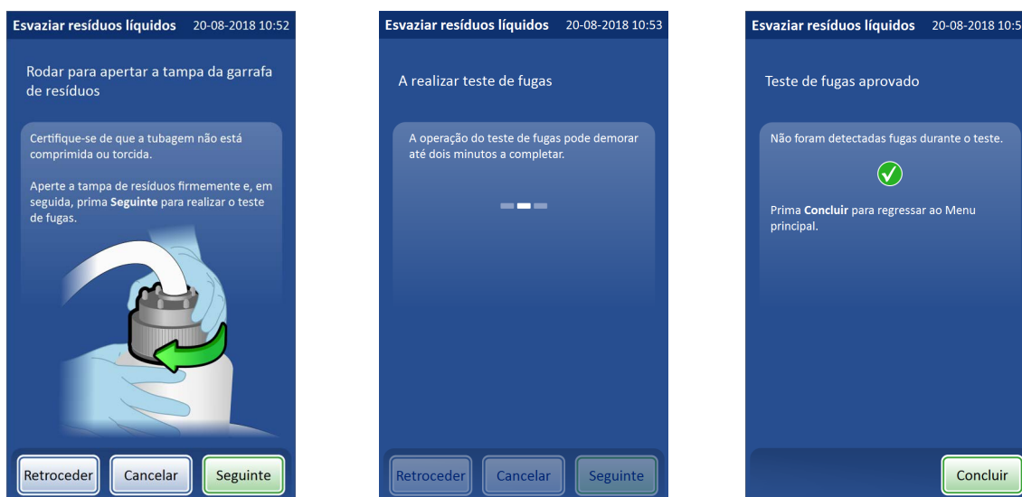
Figura 8-17 Aperto da tampa e execução do teste de vazamento do sistema de resíduos
