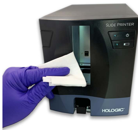
Figura 8-11 Limpar o rolo de entrada da impressora de lâminas
