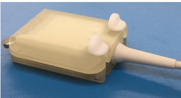
Figure 1-7 : Protecteur de connecteur de la sonde IUUS Sonata fermé hermétiquement sur le connecteur de la sonde IUUS
