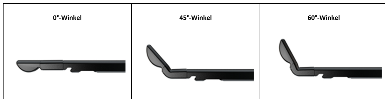
Abbildung 1-2 Winkelgrad-Beispiele der abwinkelbaren Spitze von 0°, 45° und 60°.
