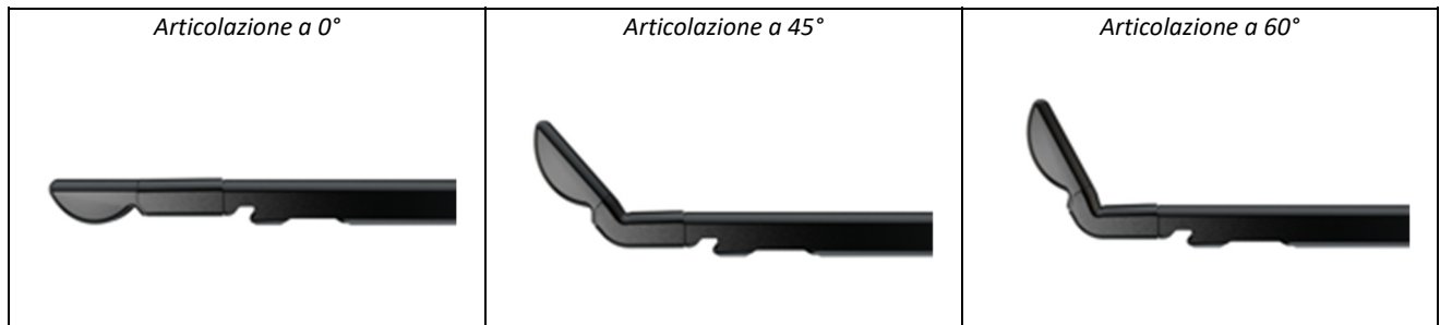
Figura 1-2. Esempi di angolazione della punta articolata a 0°, 45° e 60°
