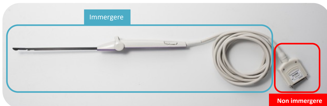
Figura 4-1. Aree della sonda IUUS da immergere
