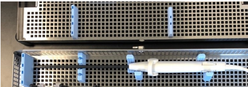
Figura 6-2. Collocazione corretta della sonda IUUS con la punta articolata su 0°
