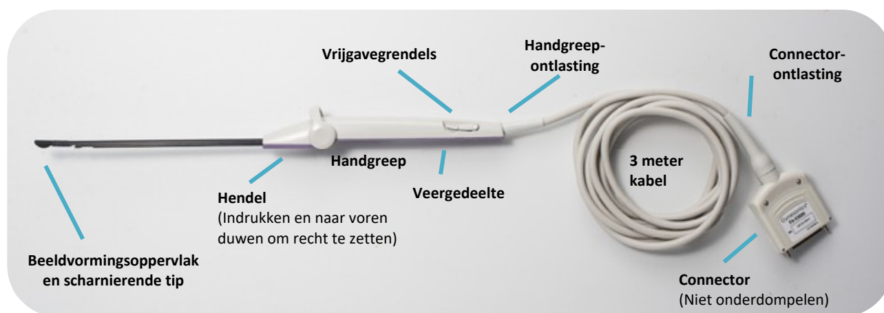
Afbeelding 1-1 Relevante onderdelen van de IUUS-probe.
