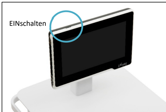
Abbildung 3-6. Zum EINSchalten den oben links am SMART Tablet befindlichen Netzschalter drücken.
