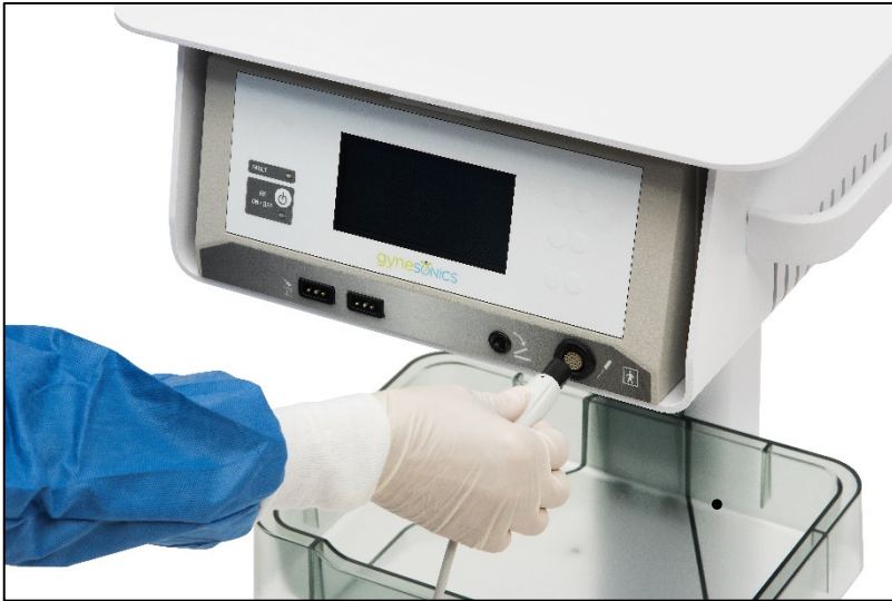
Abbildung 3-22. RFA-Handstückkabel an Vorderseite des RF-Generators anschließen.
