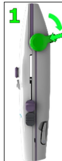
Abbildung 4-33. Zum Zurückversetzen der IUUS-Sondenspitze in die 0°-Stellung den Abwinkelungshebel drücken und vorschieben.
