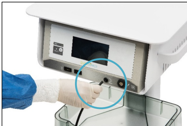
Abbildung 3-5. Den Fußschalter an die Vorderseite des RF-Generators anschließen.
