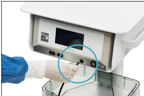
Figure 3-5. Fixer la pédale à l'avant du générateur RF.
