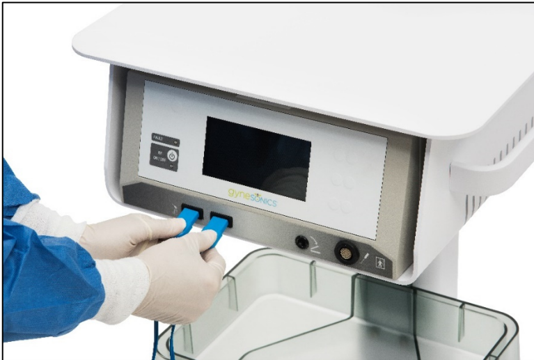
Figure 3-15. Raccorder les deux câbles des électrodes dispersives à l'avant du générateur RF.
