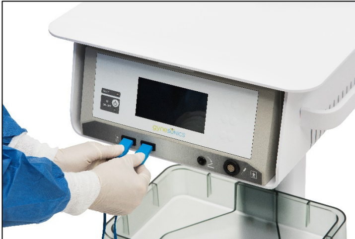
Figure 5-1. Débrancher les câbles des électrodes dispersives du générateur RF.
