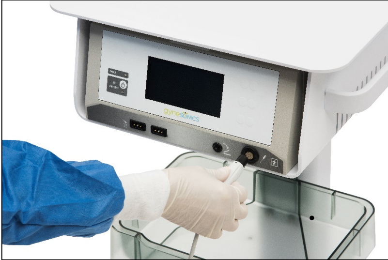
Figure 3-22. Raccorder le câble de pièce à main ARF à la partie avant du générateur RF.
