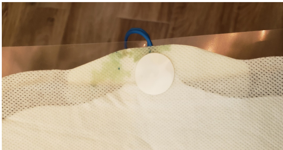
Figure 3-12. Taches superficielles sur le tissu de l'électrode dispersive.
