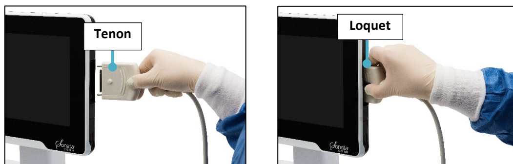
Figure 3-21. Raccorder la sonde IUUS à la SMART Tablet et faire coulisser le loquet pour la verrouiller.
