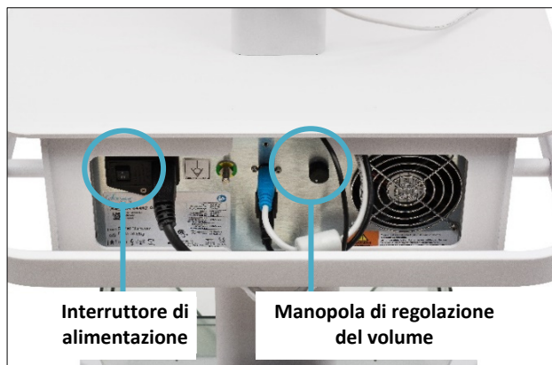
Figura 3-4. Pannello posteriore del generatore RF che mostra l'interruttore di alimentazione e la manopola di regolazione del volume
