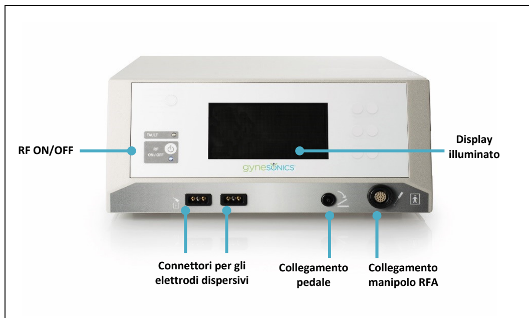
Figura 2-9. Comandi e connettori sul pannello anteriore del generatore RF
