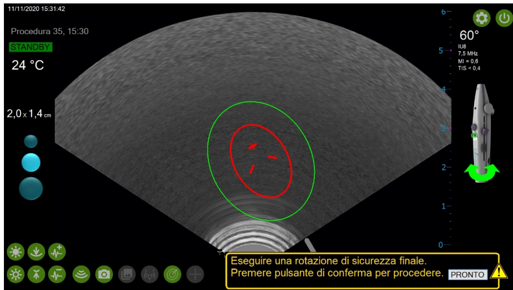
Figura 4-24. Quando gli elettrodi ad ago sono estesi alla profondità desiderata, i contrassegni delle punte degli elettrodi diventano rossi.
