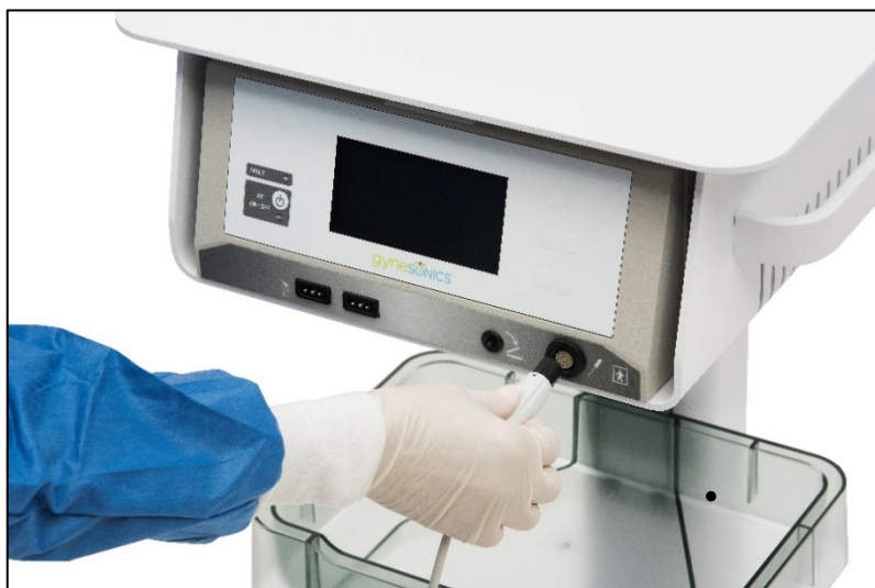
Afbeelding 3-22. Kabel van het RFA-handstuk op de voorkant van de RF-generator aansluiten.
