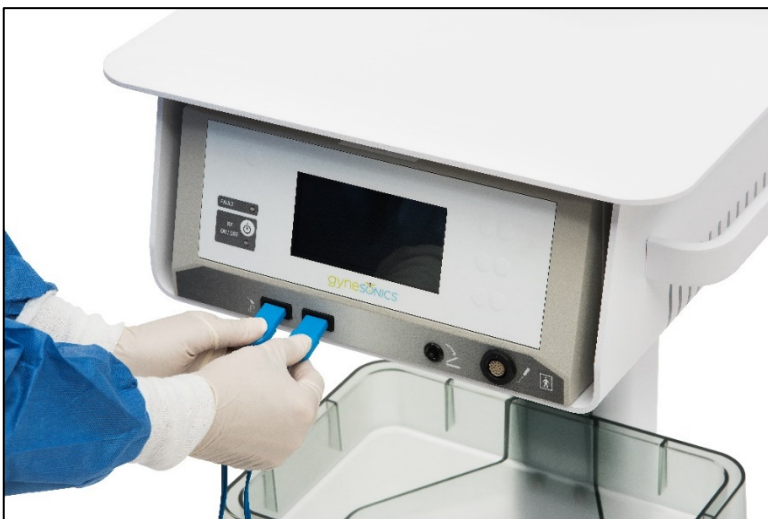
Afbeelding 3-15. De kabels van beide patiëntenplaten op de voorkant van de RF-generator aansluiten.
