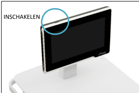
Afbeelding 3-6. INSCHAKELEN door op het SMART Tablet in de linkerbovenhoek op de aan-uitknop te drukken.
