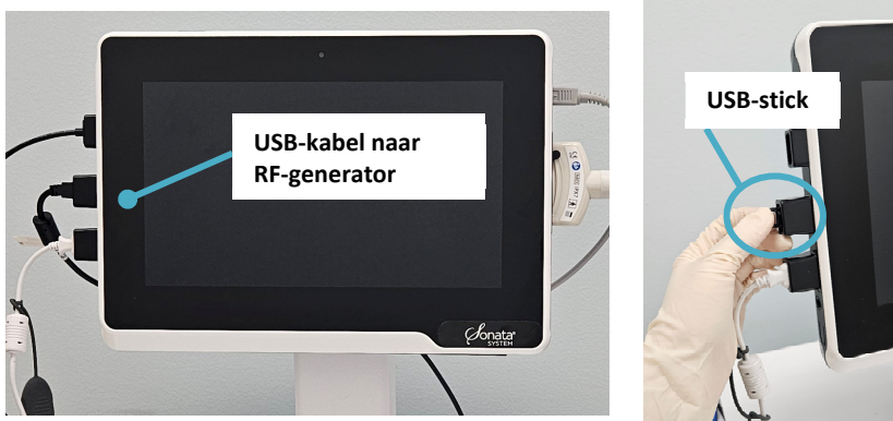
Afbeelding 6-16. Neem de USB-kabel uit de USB-poort en steek de USB-stick in de USB-poort.
