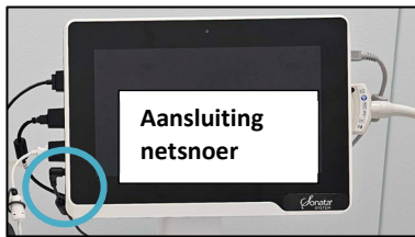
Afbeelding 3-3. Aansluiting netsnoer op SMART Tablet.
