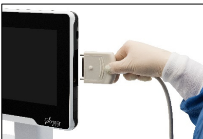
Afbeelding 5-4. IUUS-probe loskoppelen van het SMART Tablet.
