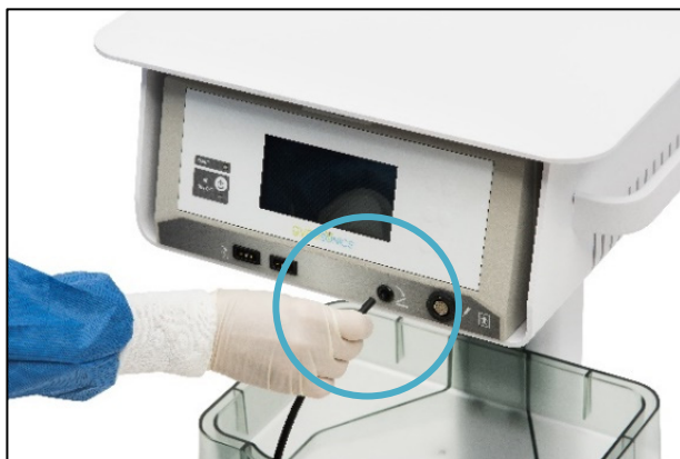
Afbeelding 3-5. Sluit het voetpedaal aan op de voorkant van de RF-generator.
