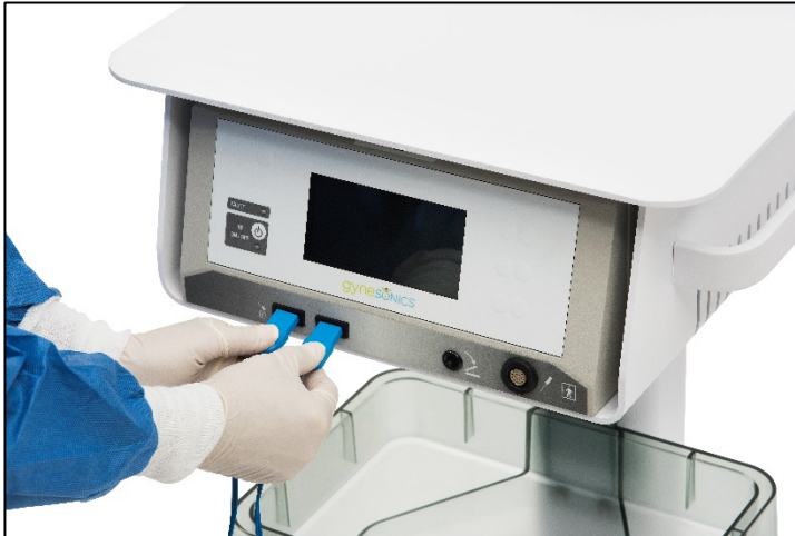
Afbeelding 5-1. De kabels van de patiëntenplaten loskoppelen van de RF-generator.
