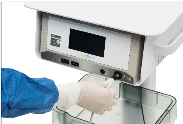
Afbeelding 5-3. Het RFA-handstuk loskoppelen.
