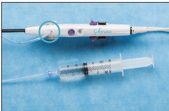
Afbeelding 2-22. Vloeistofinфуuspoort op het RFA-handstuk.
