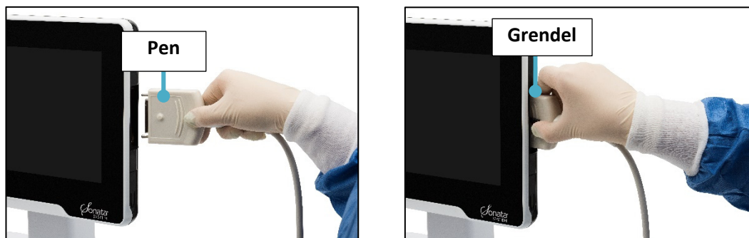
Afbeelding 3-21. De IUUS-probe op het SMART Tablet aansluiten en de grendel schuiven om te vergrendelen.
