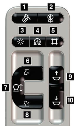
Figura 9: Painel de controle do braço-C
