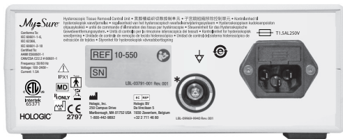
Kuva 2. MyoSure-ohjausyksikkö – takapaneeli (*=potentiaalintasausliitin)
