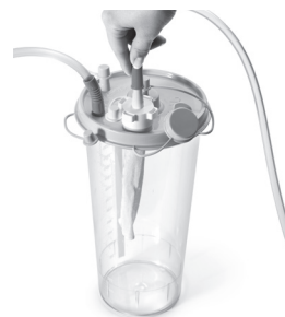
Figur 7. Fest vakuumslangen til oppsamlingsbeholderen
