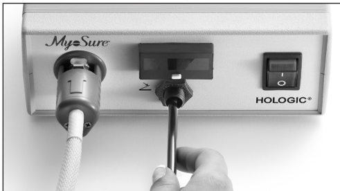
Figura 6. Inserimento del cavo guida e del pedale nell'unità di controllo
