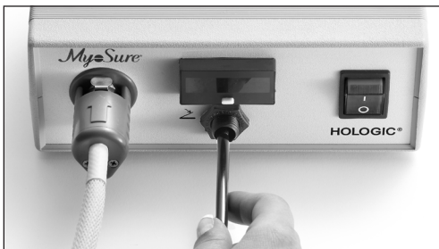
Abbildung 6. Anstecken des Antriebskabels und des Fußpedals an der Steuereinheit
