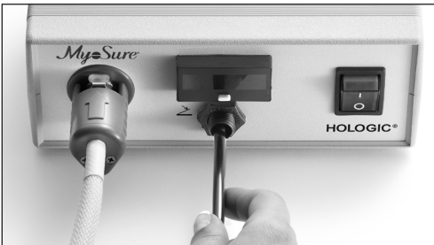
Figur 6. Sätt in drivkabeln och fotpedalen i kontrollenheten
