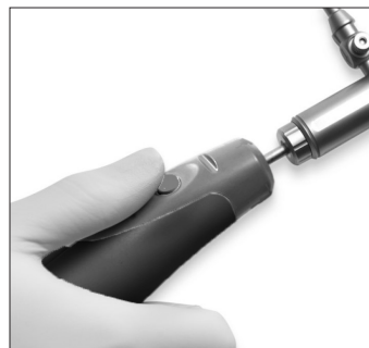
Figur 10. Indsugningsknap til at frigøre synsfeltet.
