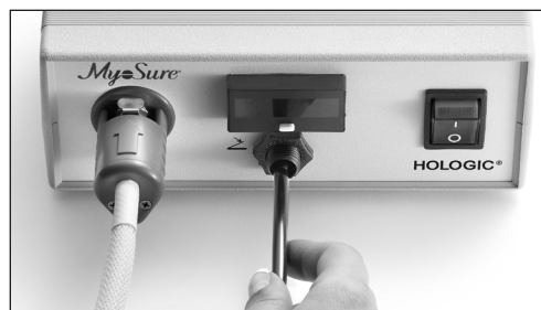
图 6. 将驱动线缆和脚踏板插入控制单元
