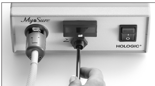
Kuva 6. Aseta käyttökaapeli ja jalkapoljin ohjausyksikköön
