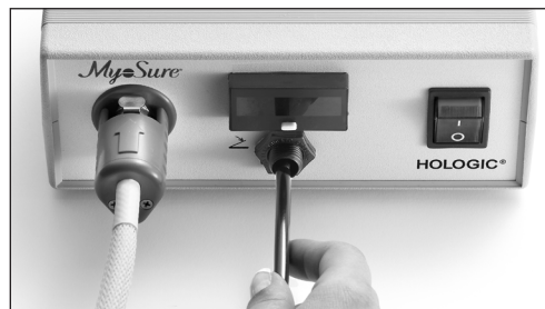
Figur 6. Sett inn drivkabel og fotpedal i kontrollenhet
