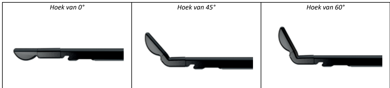
Afbeelding 1-2 Voorbeelden van scharnierende tip in hoek van 0°, 45° en 60°.
