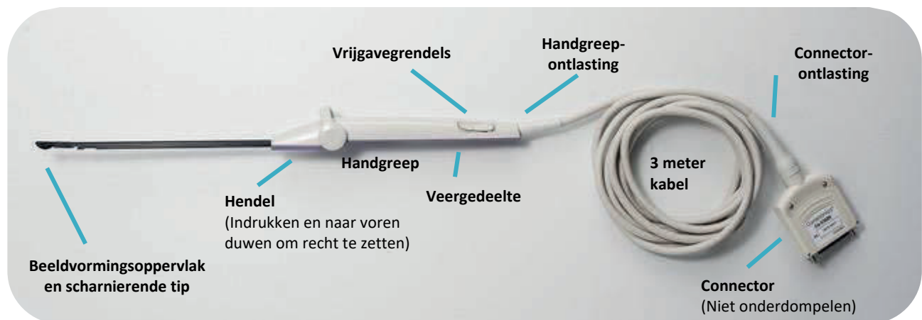
Afbeelding 1-1 Relevante onderdelen van de IUUS-probe.
