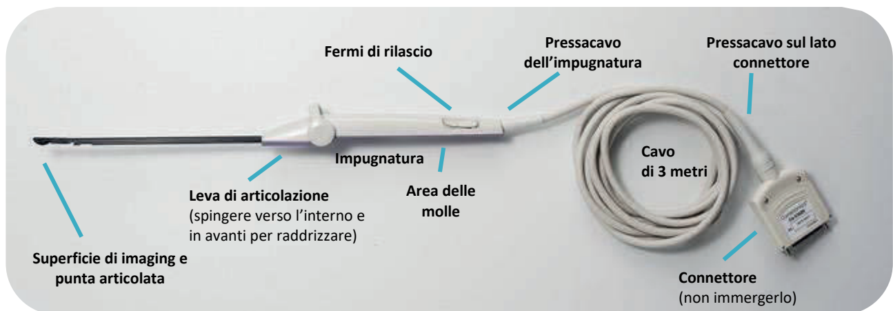
Figura 1-1. Componenti principali della sonda IUUS
