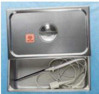
Figure 1-4 Utiliser un récipient étanche muni d'un couvercle pour transporter la sonde IUUS au laboratoire de traitement central.
