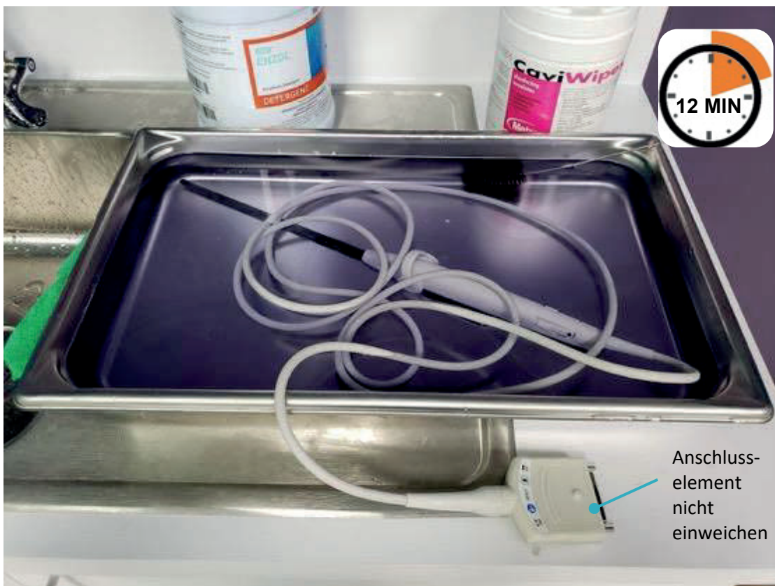
Abbildung 4-2 Mit einer ausreichenden Lösungsmenge füllen, sodass das Produkt vollständig bedeckt ist.
