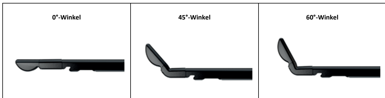
Abbildung 1-2 Winkelgrad-Beispiele der abwinkelbaren Spitze von 0°, 45° und 60°.
