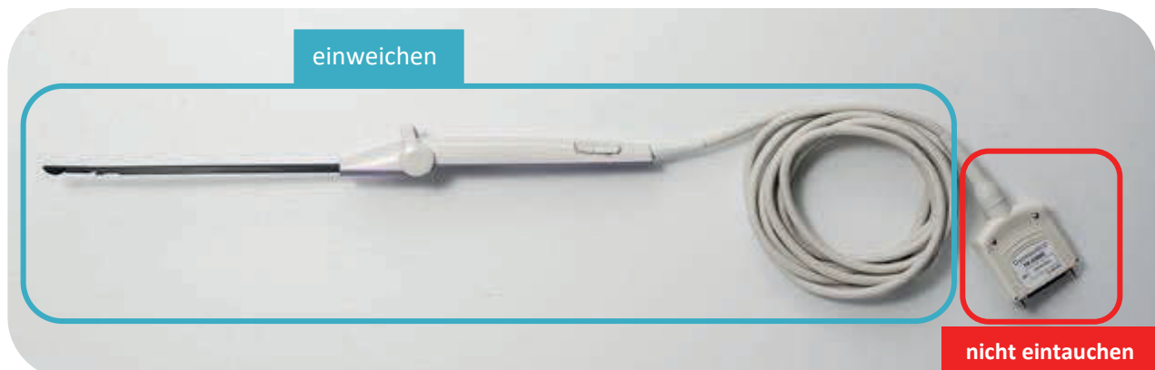
Abbildung 4-1 Einzuweichende Bereiche der IUUS-Sonde.
