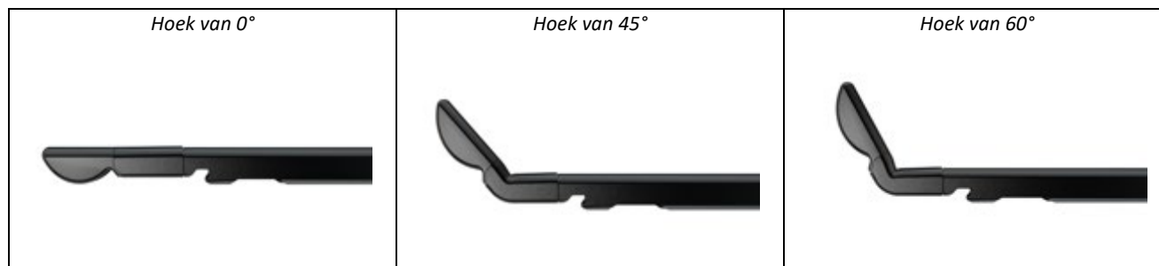
Afbeelding 1-2 Voorbeelden van scharnierende tip in hoek van 0°, 45° en 60°.
