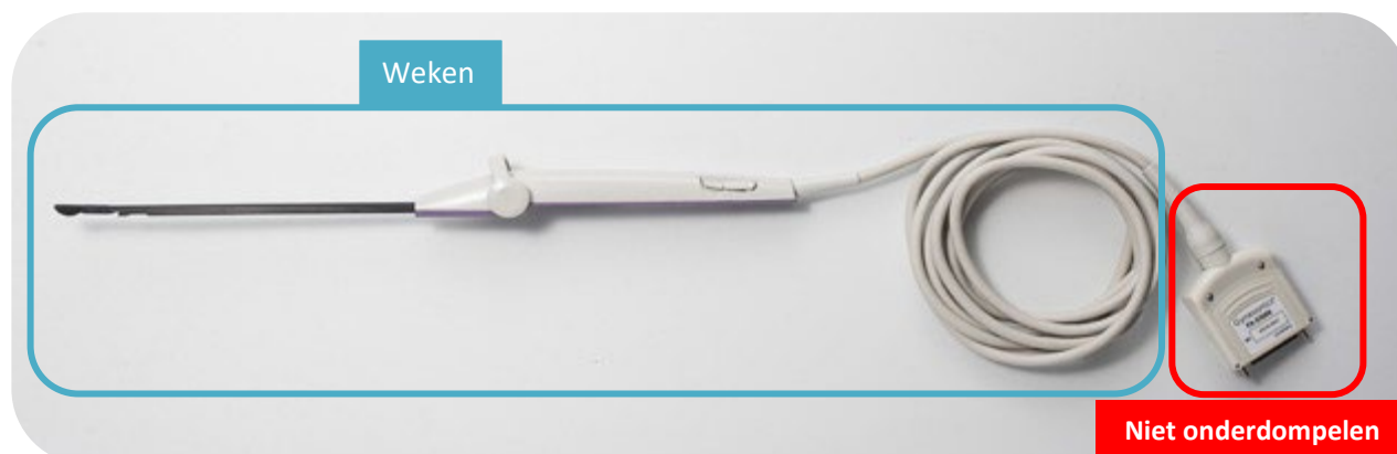
Afbeelding 4-1 Gebieden van de IUUS-probe die geweekt moeten worden.
