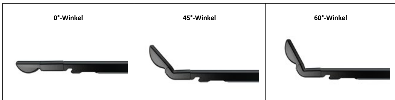
Abbildung 1-2 Winkelgrad-Beispiele der abwinkelbaren Spitze von 0°, 45° und 60°.
