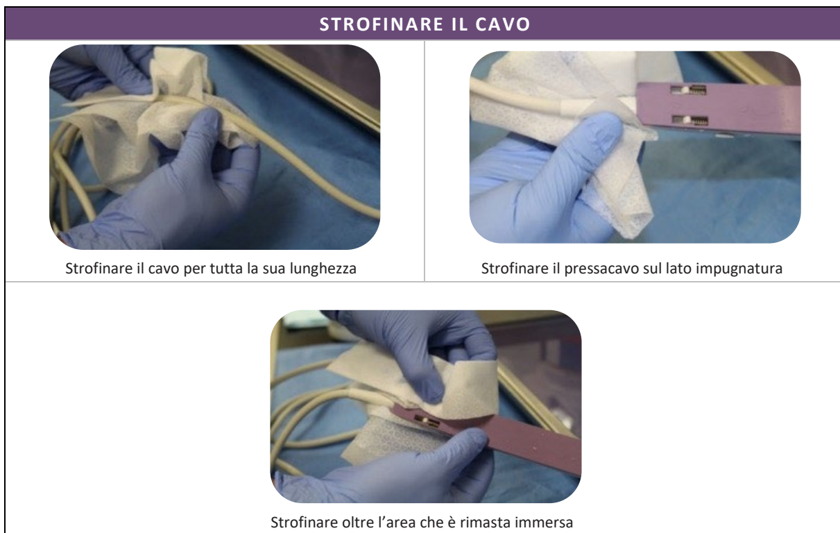
Figura 4-6. Strofinare almeno due volte con salviette disinfettanti per superfici a basso tenore di alcol di qualità ospedaliera, usando una salvietta nuova ogni volta
