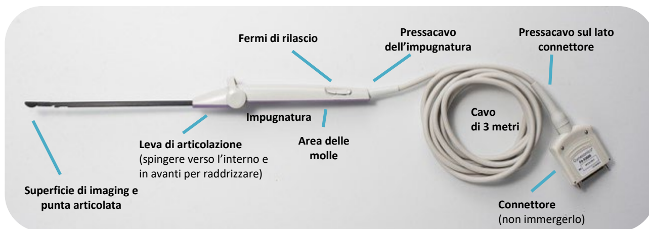
Figura 1-1. Componenti principali della sonda IUUS
