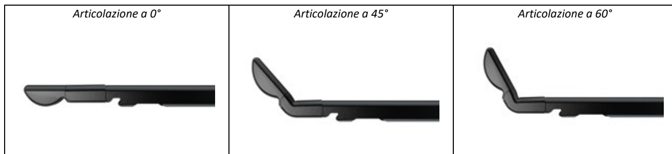
Figura 1-2. Esempi di angolazione della punta articolata a 0°, 45° e 60°
