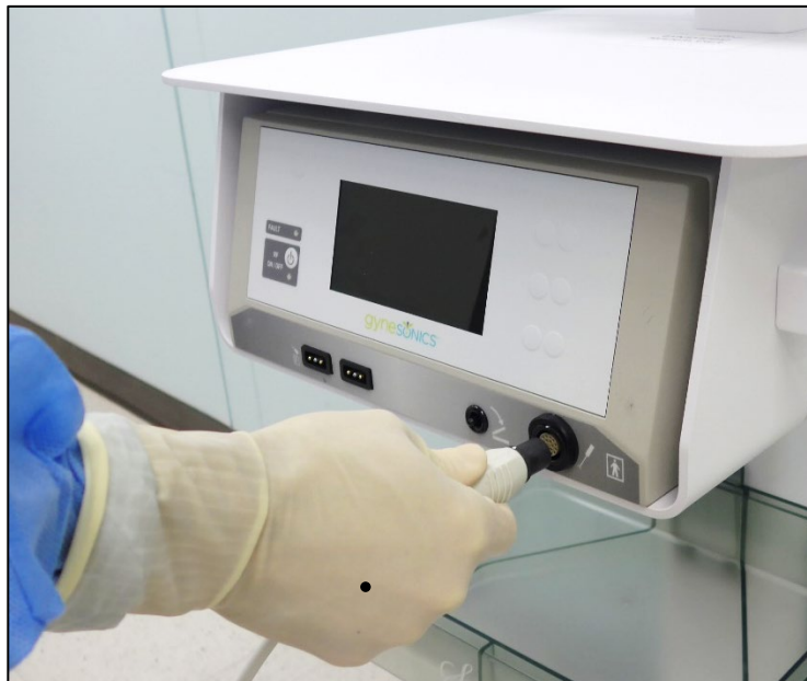
Abbildung 2-3. RFA-Handstück an Vorderseite des RF-Generators anschließen.
