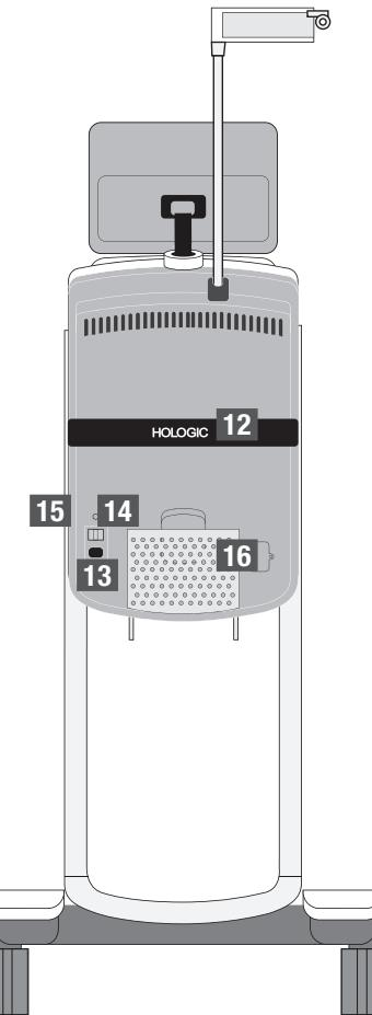
Figura 2: Pannello posteriore della console del sistema di gestione dei fluidi Fluent
