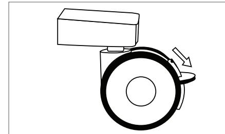
Dispositif de verrouillage des roulettes
